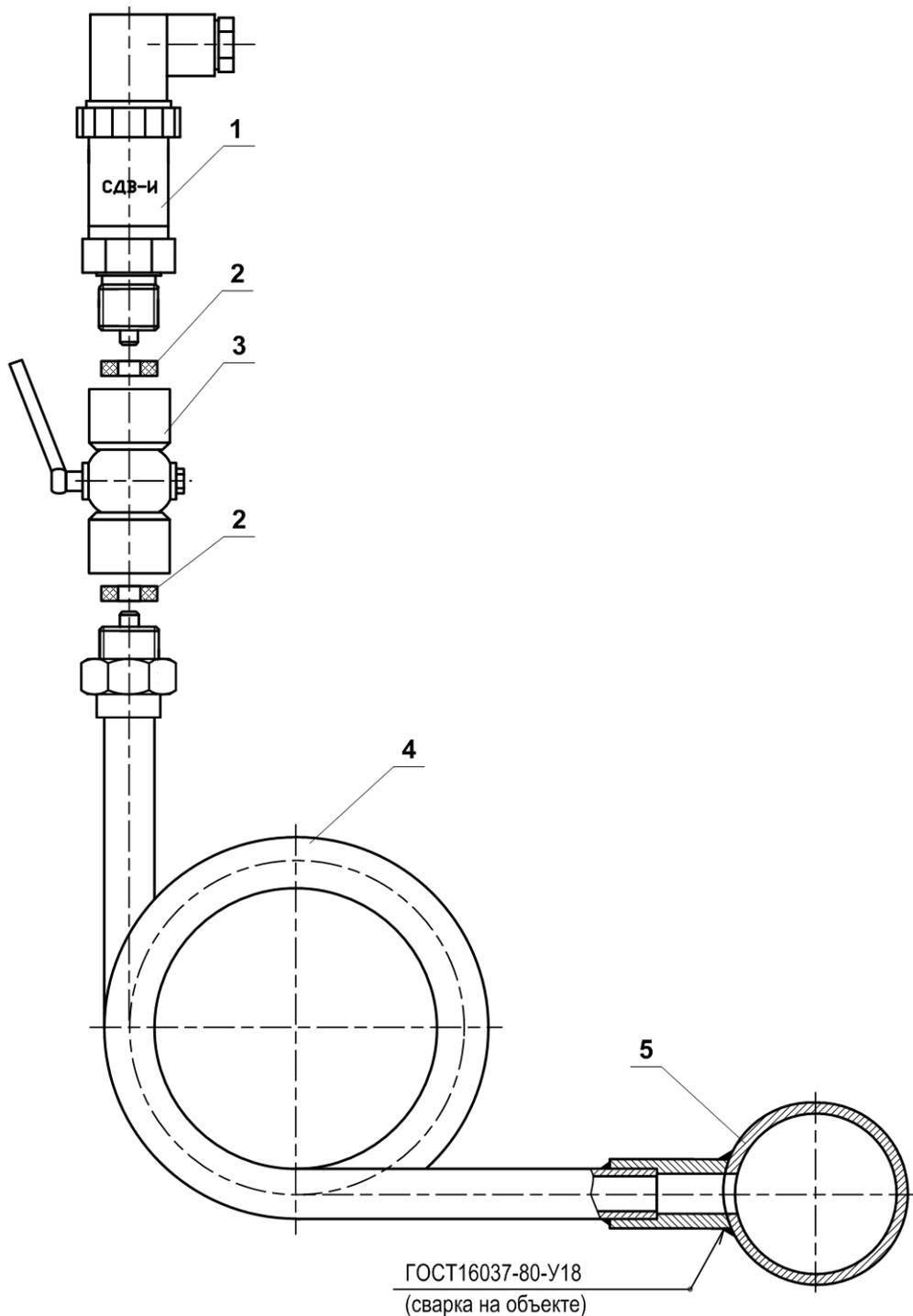
1 – преобразователь давления; 2 – прокладка (из комплекта поставки); 3 – трехходовой кран; 4 – трубка петлевая;
