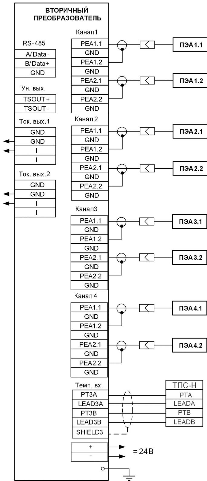
Рис.Б.1. Схема соединений расходомеров исполнения УРСВ-544 Н.
