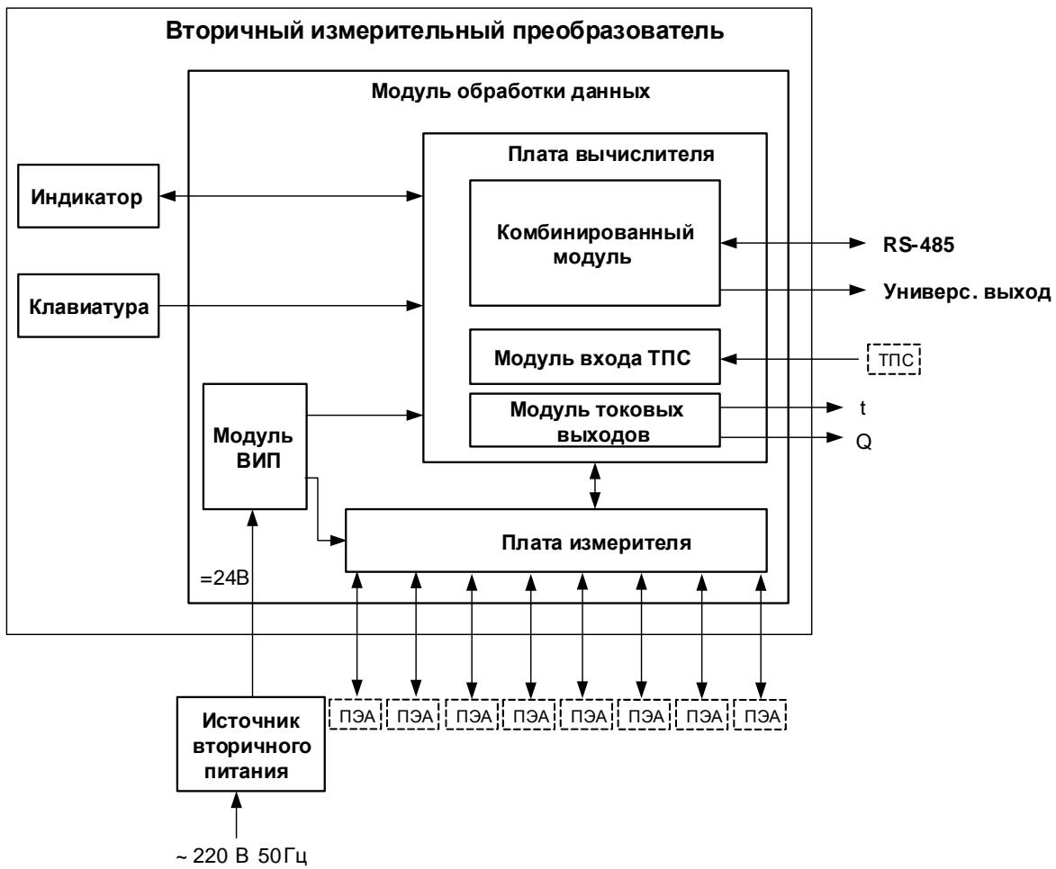
$t$ ,  $Q$  – температура и расход; ВИП – встроенный источник питания; ПЭА – преобразователь электроакустический; ТПС – термо-преобразователь сопротивления.
