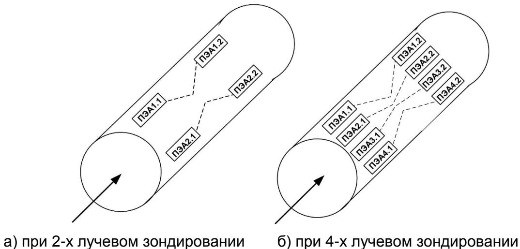
**Рис.3. Расположение пар ПЭА по сечению трубопровода.**
