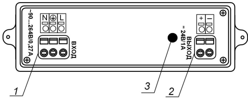
1 – контактная колодка для подключения к сети ~220 В 50 Гц и шине защитного заземления; 2 – контактная колодка выходного напряжения; 3 – светодиод индикации работы ИВП.
