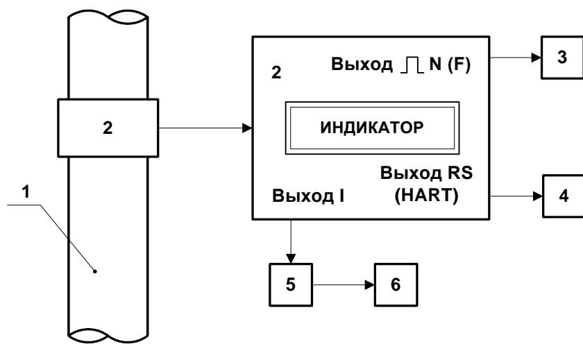
1 – трубопровод поверочной установки; 2 – расходомер; 3 – счетчик импульсов (частотомер); 4 – персональный компьютер; 5 – магазин сопротивлений; 6 – вольтметр.
