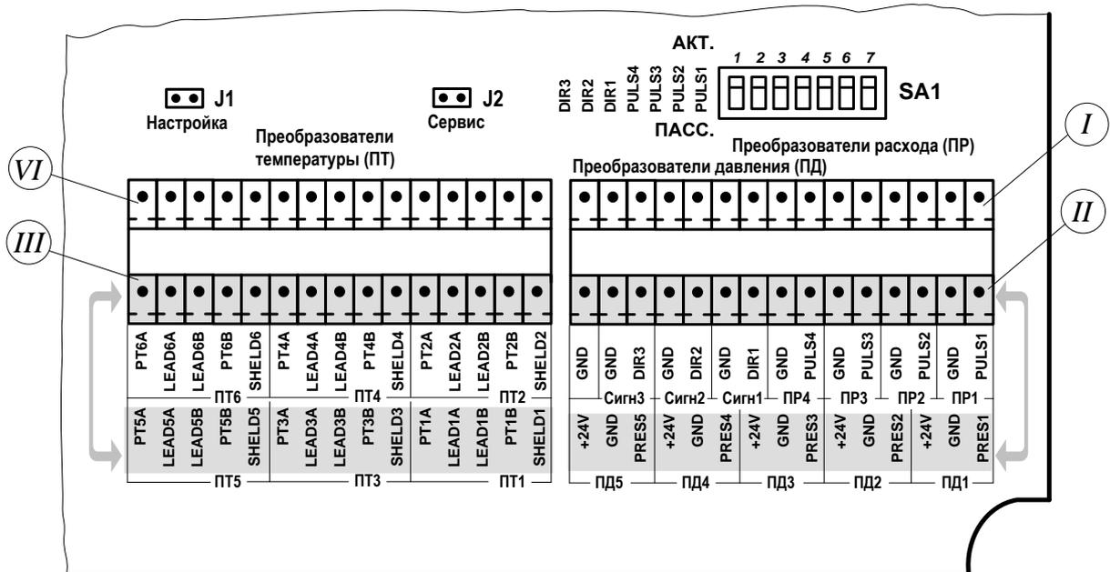
*J1, J2 – контактные пары разрешения модификации калибровочных параметров и параметров функционирования соответственно;*
