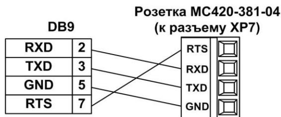
*Один из разъемов стандартного нуль-модемного кабеля обрезать и подключить к розетке MC420-381-04 согласно рисунку.*
