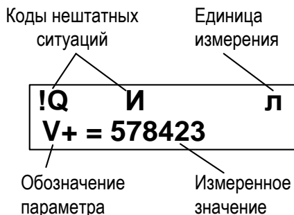
Рис.4. Размещение информации на индикаторе расходомера.
