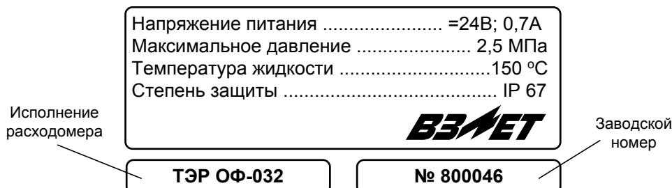
Рис.3. Вид шильда расходомера в едином конструктиве.
