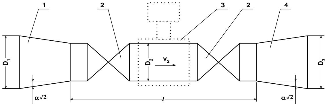
**Рис.5. Схема трубопровода в месте установки ППР.**
