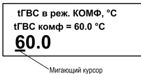
Рис.3. Пример индикации и установки температуры ГВС в режиме КОМФОРТ в окне укрупненной индикации.
