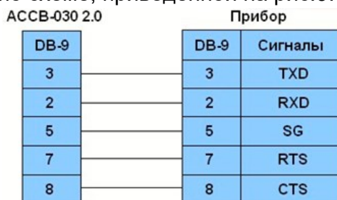
Рис.9. Подключение прибора по интерфейсу RS-232.
