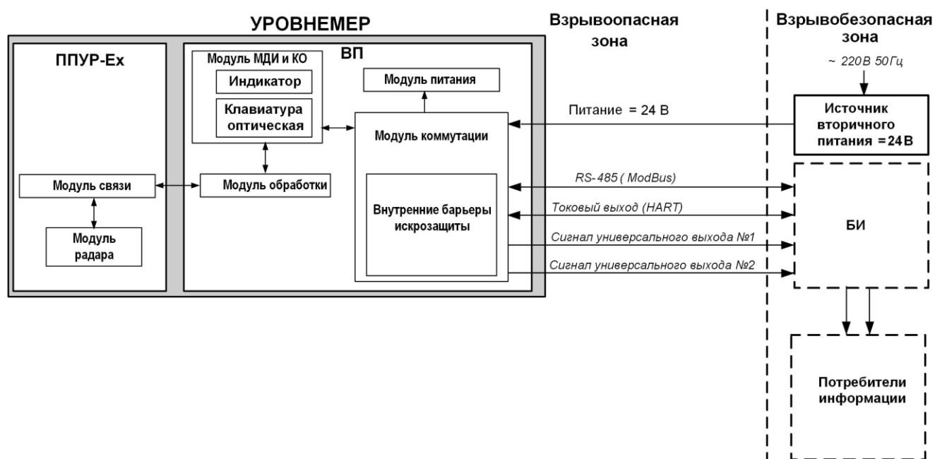
Рис.2 - Структурная схема уровнемера.
