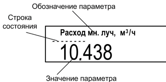
Рис.7 - Вид окна укрупненной индикации измеряемого параметра.
