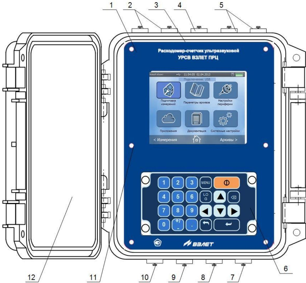
1 – лицевая панель; 2 – разъемы для подключения датчиков температуры; 3 – дисплей; 4 – разъем для подключения датчика давления; 5 – разъемы связи с ПЭА; 6 – клавиатура; 7 – разъем внешнего электропитания; 8 – разъем импульсного выхода; 9 – разъем интерфейса RS-485; 10 – разъем интерфейса USB; 11 – место для установки пломбировочной чаши; 12 – крышка ВП.
