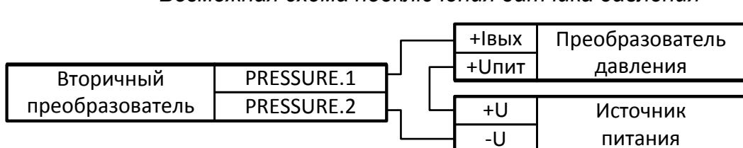
**Рис.А.3. Маркировка контактов и обозначение сигналов на разъемах ВП.**
